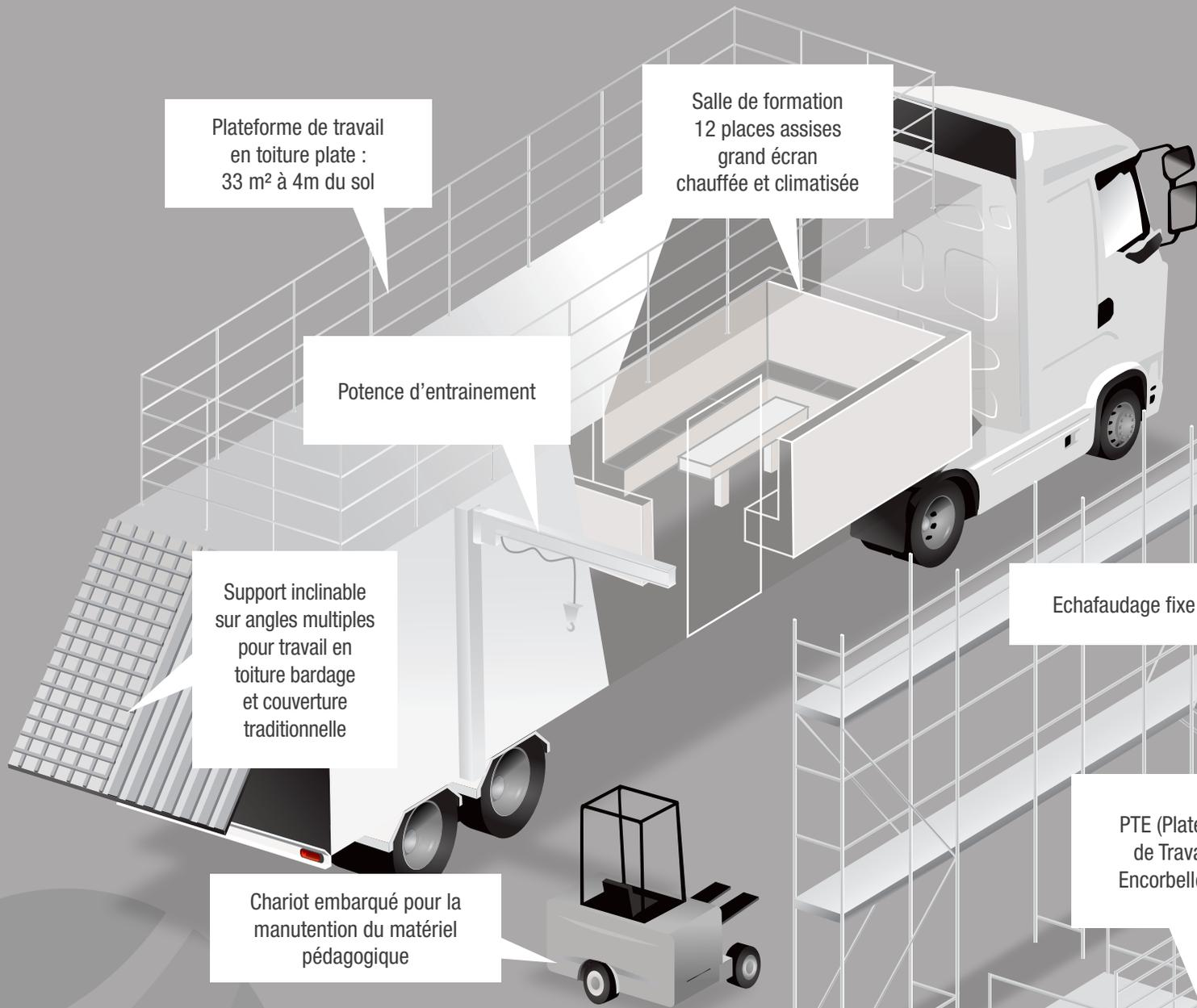
Plateforme de travail en toiture plate : 33 m<sup>2</sup> à 4m du sol
